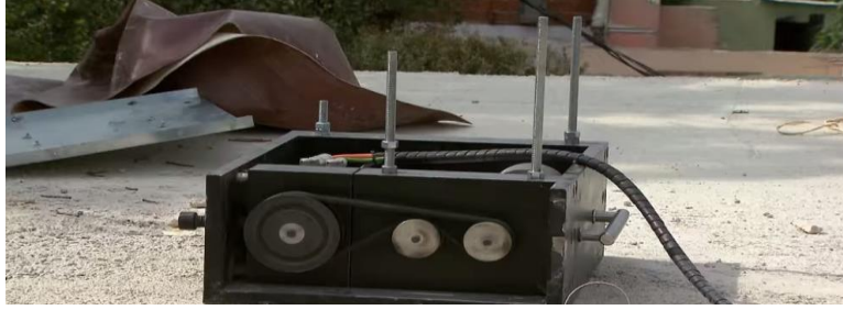
Şekil 2. İTÜ İnşaat Mühendisliği Bölümü’nün 2014 yılında gerçekleştirdiği Mevcut Binalarda Tam Ölçekli Deneylerle Deprem Performansının Saptanması Projesinde kullanılan TESTBOX™-SHAKER Sarsıcısı
